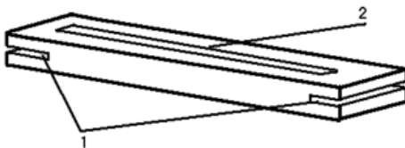
Рис. 4. Схема балки для фиксации индикаторов линейных перемещений: 1 – поперечные пазы; 2 – продольная прорезь.
